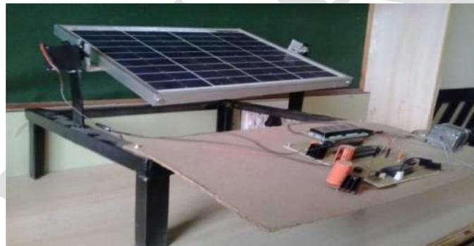
**Fig: 1.5.3.b) Single Axis Solar Tracker**
