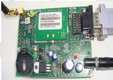
**Fig. 4 GSM Module**
