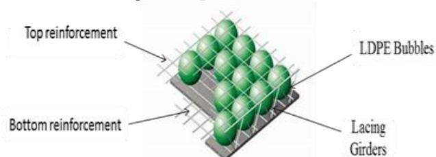
Fig - 1 Bubble Deck slab<sup>[2]</sup>
